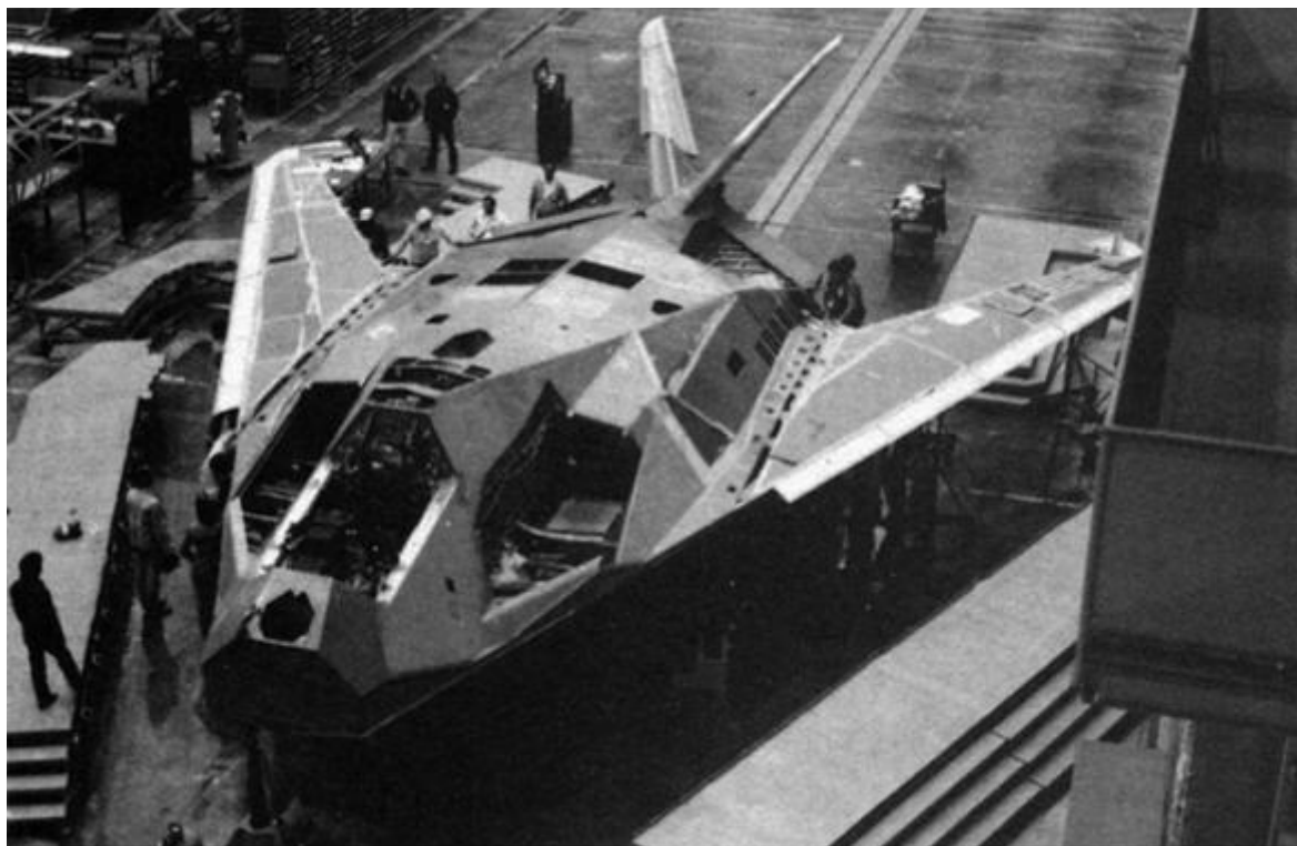
Первый серийный малозаметный истребитель на сборочном заводе Skunk Works в 1980 году. (Фото Локхид)
